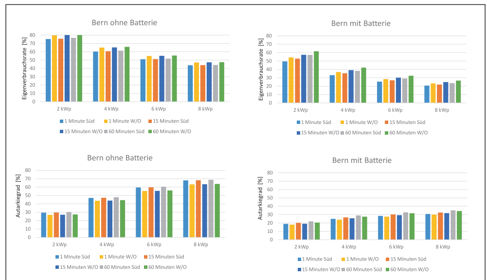
Abb. 7: Durchschnittliche Eigenverbrauchsrate (oben) und Autarkiegrad (unten) bei verschiedenen Zeitschritten und ohne (links) bzw. mit (rechts) Batterie von drei EFH bei unterschiedlicher PV-Leistung am Standort Bern.
