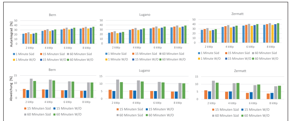
Abb. 6: Durchschnittlicher Autarkiegrad (oben) und prozentuale Abweichung gegenüber 1-Minuten-Zeitschritt (unten) der 74 EFH bei unterschiedlicher PV-Leistung und Standorten.
