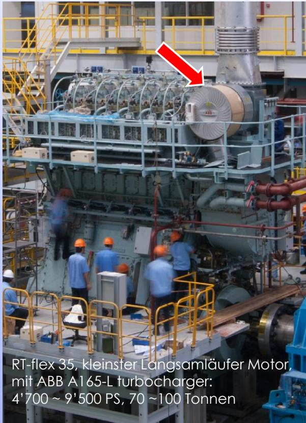
RT-flex 35, kleinster Langsamläufer Motor,
