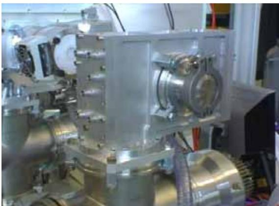
Abbildung 1: Massenspektrometer montiert auf einem UHV-Pumpenteststand
