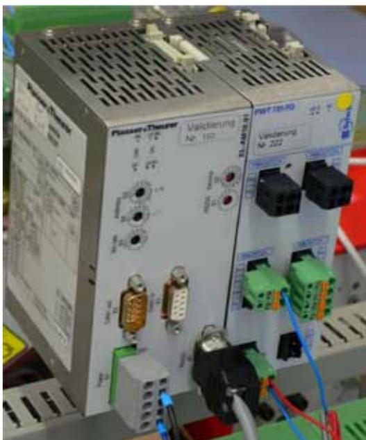
Abbildung 1: Regelkreismodul an CPU
