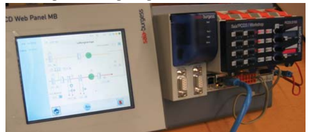
Abbildung 2: Saia PCD3 mit Web Panel
