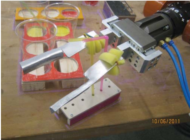
Abbildung 1: Robotergreifer angepasst für Milchshake-Handling
