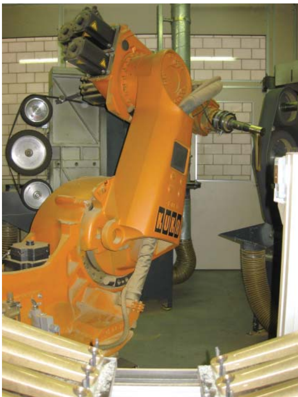
Abbildung 1: Roboterschleifzelle zur Produktion von Armaturen bei KWC AG
