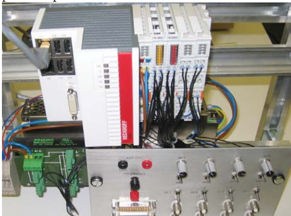
Abbildung 1: Der Laboraufbau mit der Beckhoff-SPS
