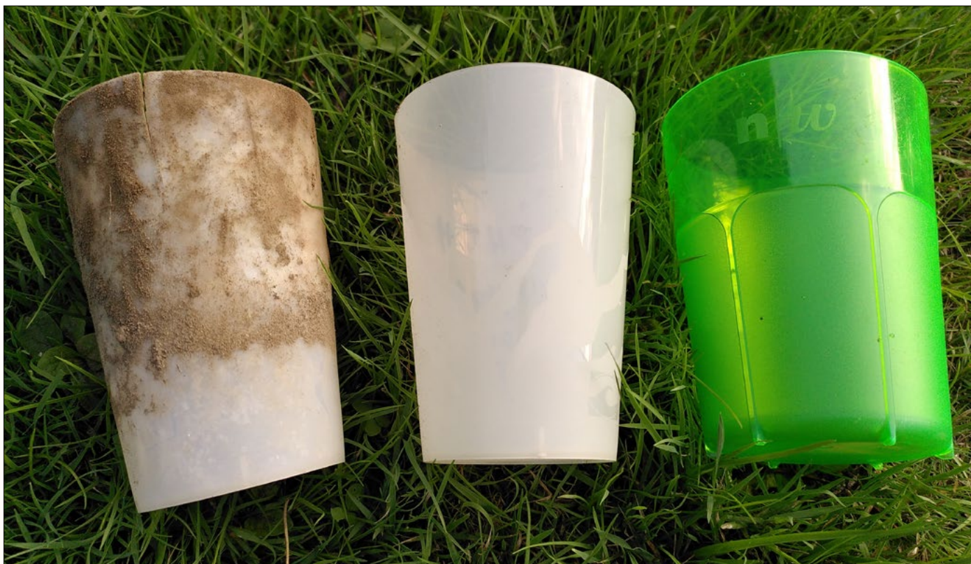
PHA-Becher nach 4 Monaten in der Erde während der Sommerzeit, neuer PHA-Becher, PC-Becher (v.l.). (Bilder: FHNW)
