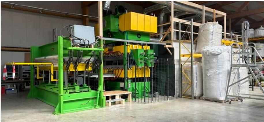
Fertigungsanlage für Sandwichplatten
