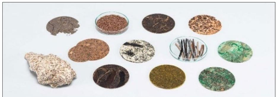
Überblick verschiedener Materialvarianten für den Einsatz in einer abbaubaren Schuhsohle. (Bilder: IKT)
