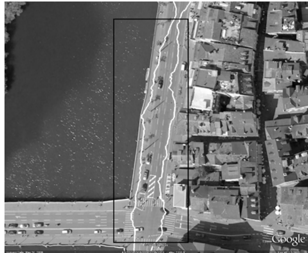
Abbildung 1: GPS-Positionen können von den wirklichen Positionen massiv abweichen (links) und nicht weit davon entfernt wieder sehr gut der Realität entsprechen (rechts)
