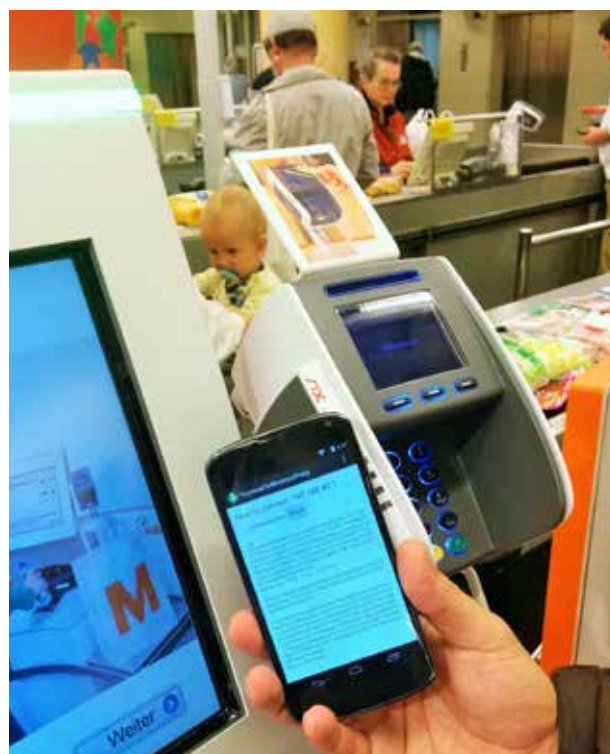
Abbildung 2: Der Bezahlvorgang beim Detailhändler ist erfolgreich, als letzter Log-Eintrag wird die kryptografische Bestätigung durch die Karte angezeigt.
