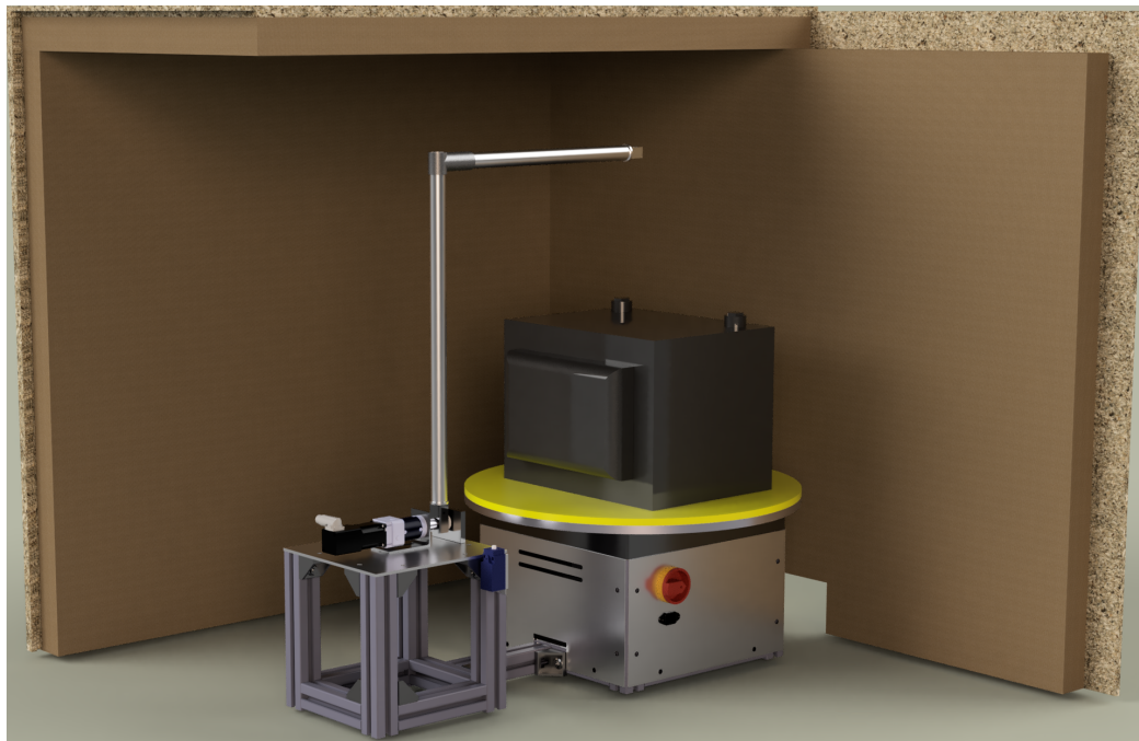
Messsystem mit Drehteller, Mikrofonhalterung und Messplatz
