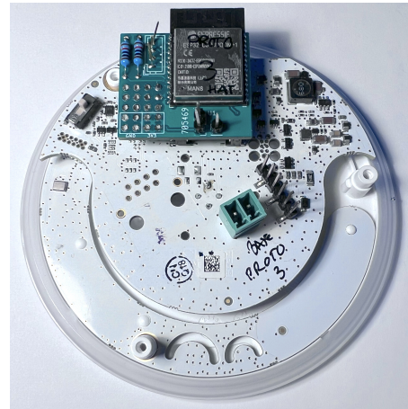
Einer von drei erstellten Prototypen mit dem mit einem ESP32-C6 bestückten Adapterboard. Dieses Modul unterstützt Thread, WiFi und Bluetooth und kann als Matter-Knoten konfiguriert werden.
