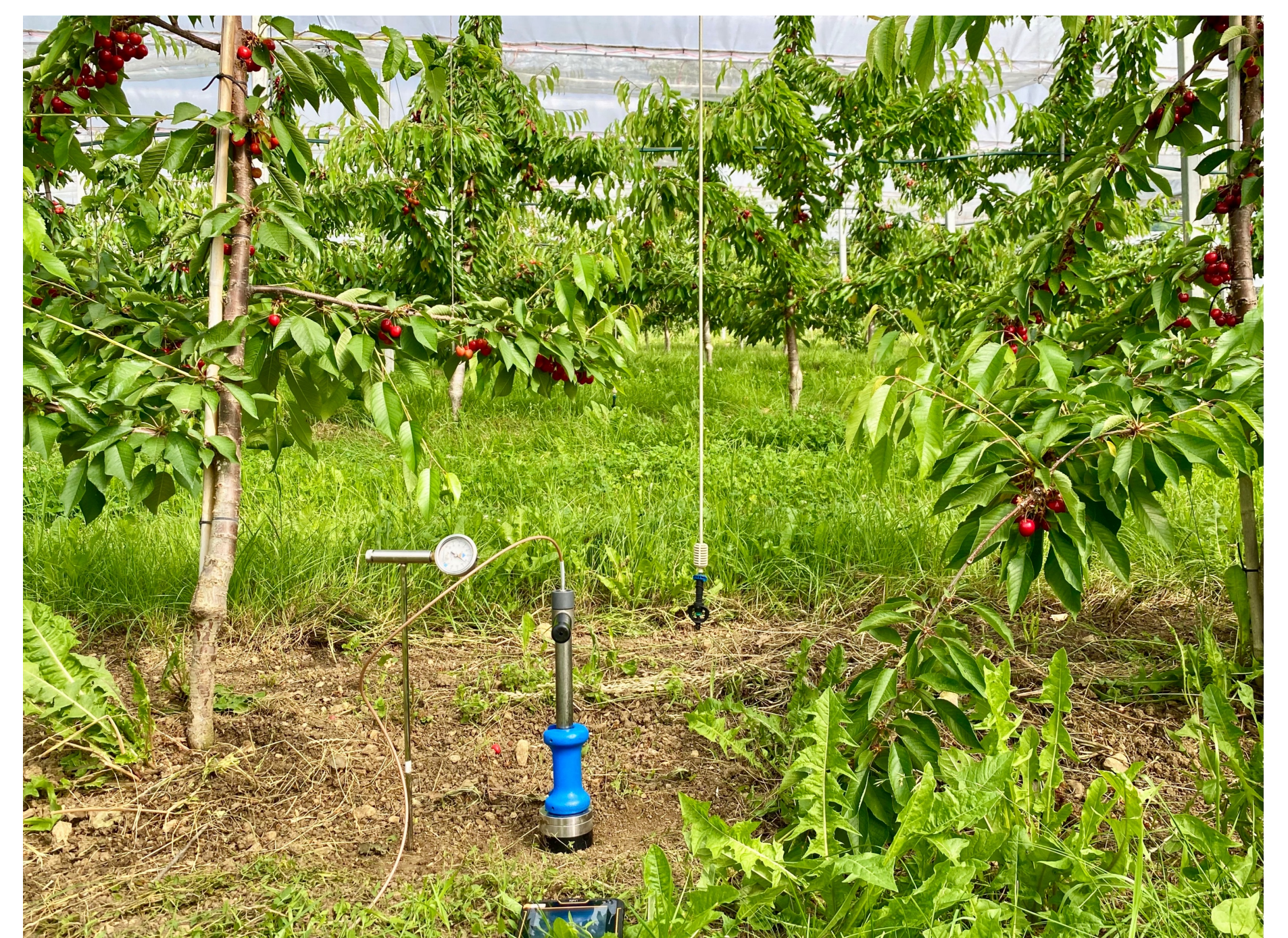
TDR-Messgerät "Handytrase" und mobiles Tensiometer "Quickdraw FS2900"
