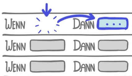
Wenn eine Regel keine Bedingungen hat, wird sie immer ausgeführt. Achtung: Regeln, die unten dieser Regel stehen, werden nie ausgeführt.
