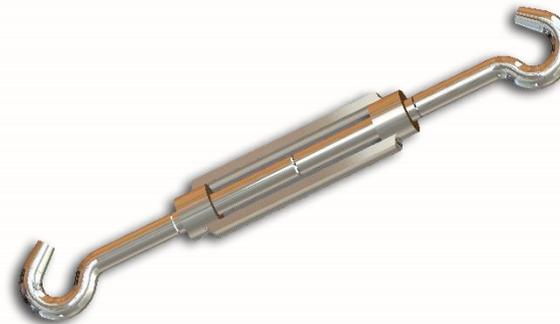
Seilspanner besitzen rechts und links einen Haken. Durch ein verstellbares Mittelteil, das auf der einen Seite ein Rechts- auf der anderen Seite ein Linksgewinde aufweist, kann man Spannung erzeugen.
