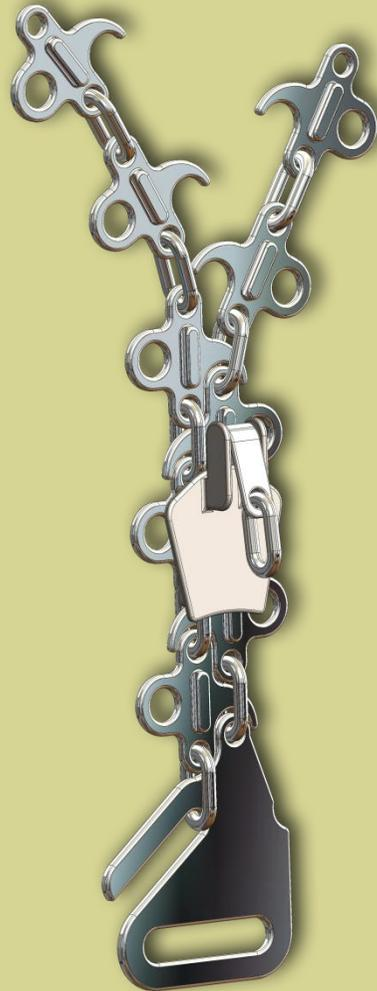
Nachbildung eines Judson-Reissverschlusses (einer der ersten Reissverschlüsse), entwickelt vom Amerikaner Judson und angemeldet zum Patent 1892 und 1893. Die genaue Funktionsweise des Schiebers ist bis heute nicht eindeutig rekonstruiert worden.
