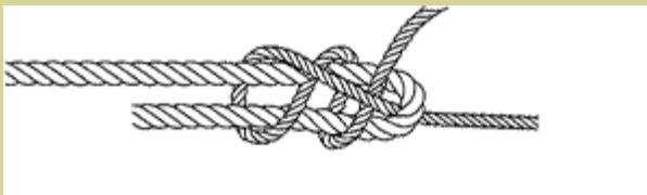
Der doppelte Schotstek ist insbesondere beim Zusammenstecken sehr unterschiedlich starker Leinen zu empfehlen.
