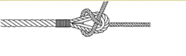
Der einfache Schotstek wird zum Verbinden von Leinen verwendet, besonders dann, wenn die Leinen unterschiedlich stark sind. Die dünnere Leine wird immer durch die Bucht der dickeren gesteckt.
