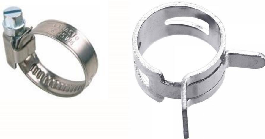
Schlauchschellen bestehen meistens aus einem ringförmigen Metallband (seltener aus Kunststoff). Zum Festziehen besitzt die Schelle meistens eine Schraube. Durch Drehen dieser Stellschraube verringert sich der Innendurchmesser der Schlauchschelle. Dadurch wird der darunter liegende Schlauch auf das Anschlussstück gepresst.
